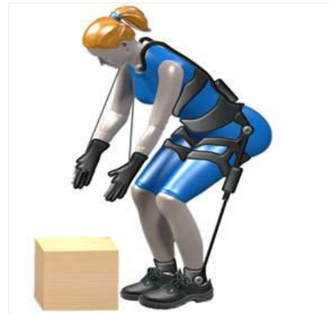
Funktionselemente der am Körper getragenen Hebehilfe (Quelle: Fraunhofer IPA).
