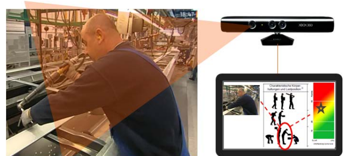
Funktionsweise des Ergonomie-Navigators. (Quelle: Schmitz Cargobull AG)
